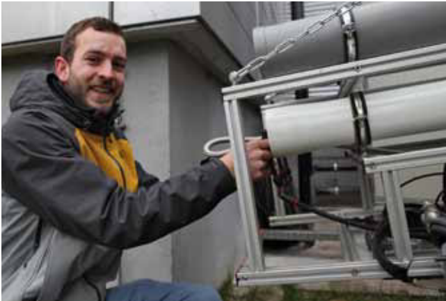
Elias Wetzel betreut das mobile HNRS. Hier wechselt er gerade den Reinigungsfilter.
